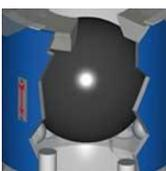
Обратный клапан изолирует вакуумную систему при отключении вакуумного насоса, не допуская движение откачиваемой среды в обратном направлении и соответственно повышения давления в вакуумной системе. Устанавливается на патрубке всасывания водокольцевого вакуумного насоса. Обратный клапан закрывается автоматически за счет перепада давления, то есть не требует подвода электропитания или сжатого воздуха.
