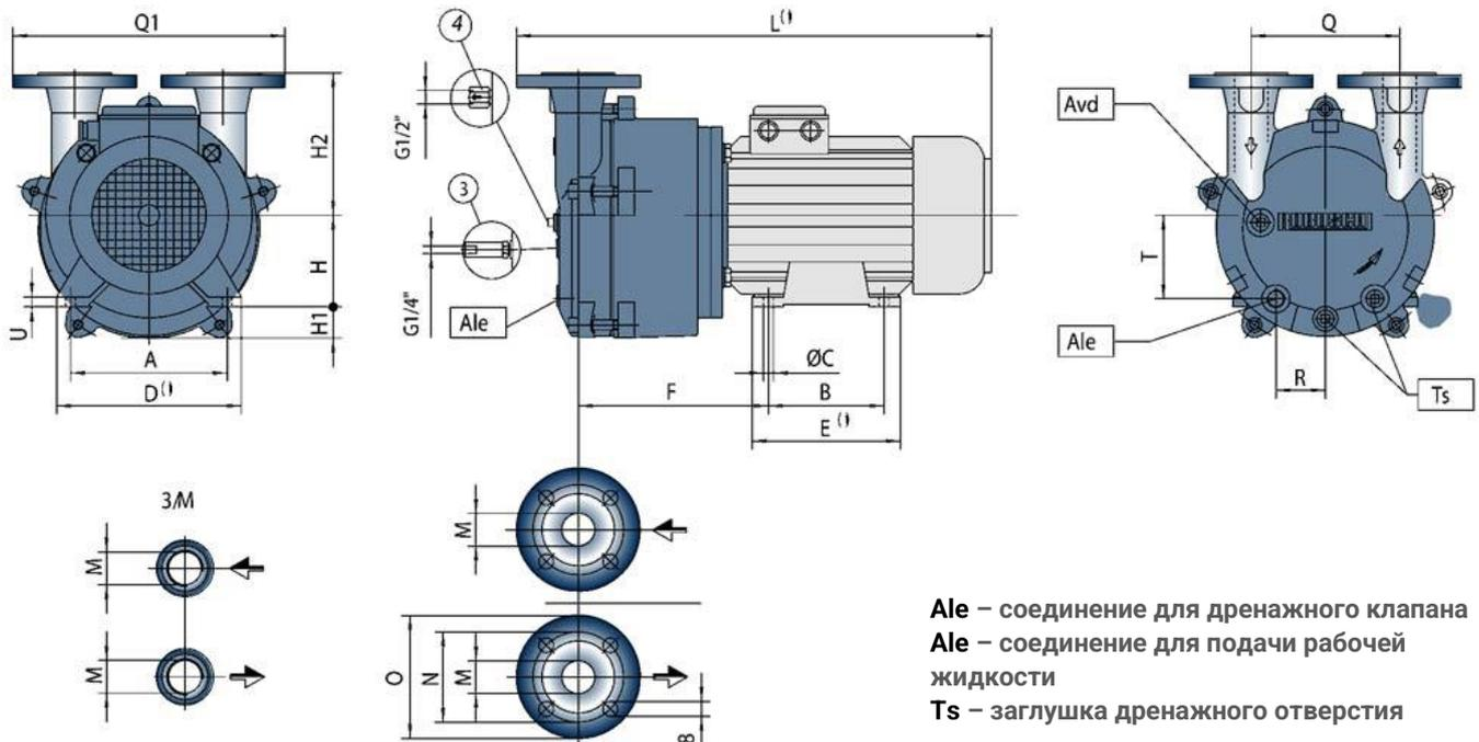
Ale – соединение для дренажного клапана
